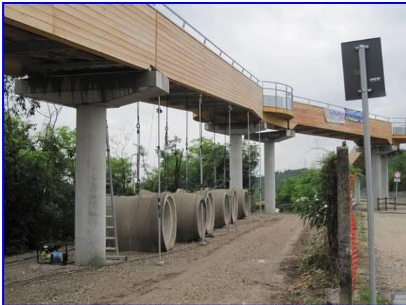
*Foto 3: Panoramica della prova di carico sulla 3<sup>a</sup> campata da nord*
