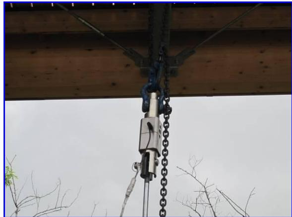
*Foto 4: Particolare della cella di carico per la lettura della forza*
