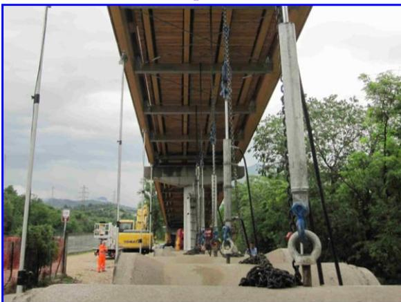
*Foto 5: Intradosso della campata durante la prova di carico*
