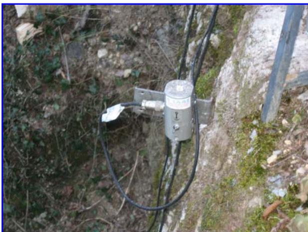
*Foto 1: Primo piano di un inclinometro utilizzato per le prove di carico*
